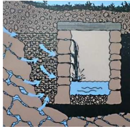
Römerkanal, Funktionsweise der Sickerleitung
